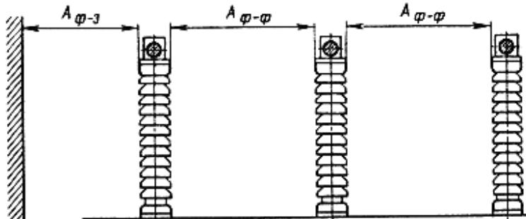
Рис. 4.2.1. Наименьшие расстояния в свету при жестких шинах между токоведущими и заземленными частями ( $A_{\phi-3}$ )
