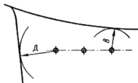
Рис. 4.2.6. Наименьшие расстояния между токоведущими частями разных цепей, расположенных
