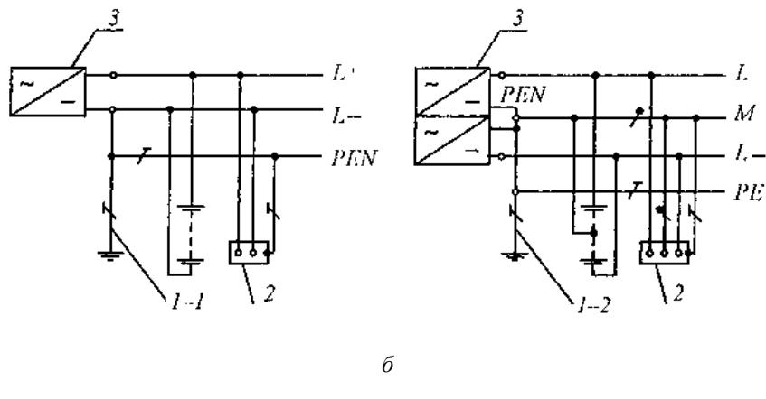
Рис. 1.7.2. Система TN—S переменного (а) и постоянного (б) тока. Нулевой защитный и нулевой рабочий проводники разделены:
