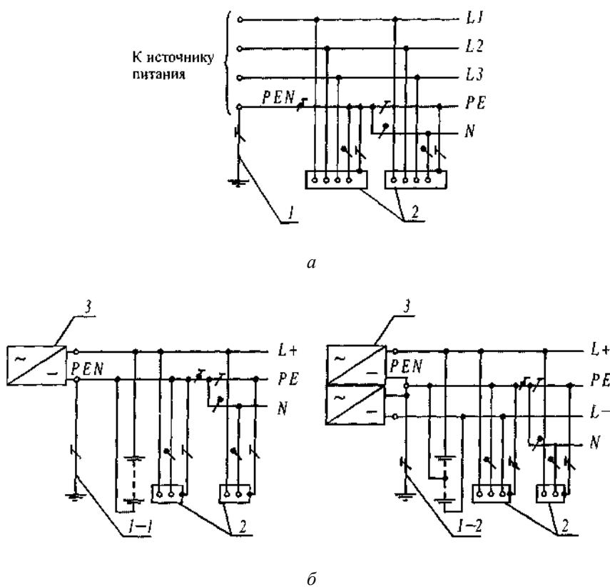
Рис. 1.7.3. Система TN-C-S переменного (а) и постоянного (б) тока. Нулевой защитный и нулевой рабочий проводники совмещены в одном проводнике в части системы:
